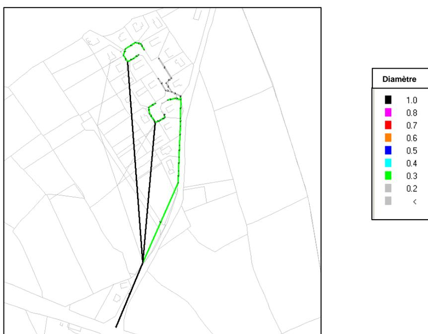
Figure 69 : Caractéristiques des réseaux de Menez Boutin
